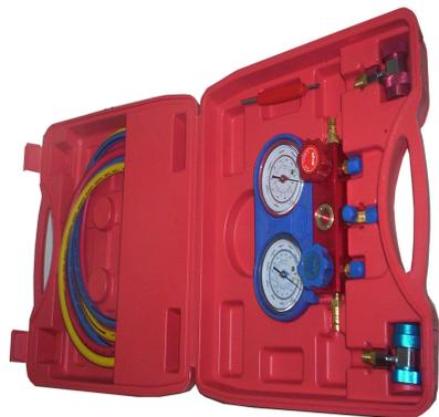
O **MFU-R134** é um equipamento destinado para medir pressão de alta e baixa para o gás R134.
