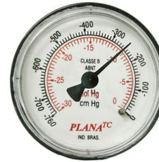
Com o motor acelerado (acima de 3000 RPM), o ponteiro apresenta uma leitura baixa, porém estável entre 3 e 15 pol Hg (100 a 380 mmHg).
