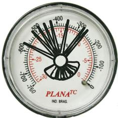
Com o motor acelerado, o ponteiro fica variando entre 10 e 22 pol Hg (280 e 580 mmHg). À medida que a rotação aumenta a oscilação do ponteiro aumenta.
