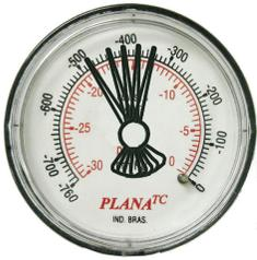
O ponteiro vibra excessivamente entre 14 e 19 pol Hg (370 a 480 mmHg) em marcha lenta, estabilizando com o aumento de rotação.
