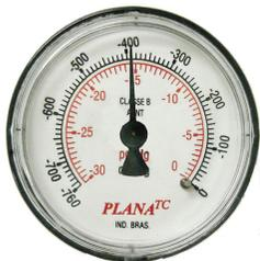
Com o motor em marcha lenta, o manômetro indica de 2 e 3 pontos abaixo do normal. Isto pode indicar também a utilização de um lubrificante de qualidade inferior.
