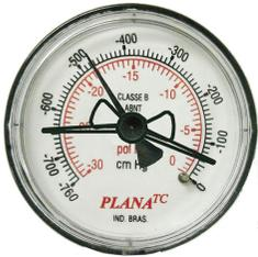
Quando o motor é acelerado, o marcador cai rapidamente até 2 pol Hg (50 mmHg) e volta para 24 ou 25 pol Hg (~650 mmHg), caindo rapidamente para a leitura de marcha lenta. Indica que os anéis e válvulas estão OK.
