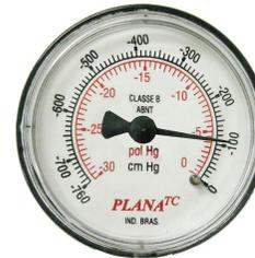
Com o motor funcionando em marcha lenta ou acelerado, o ponteiro registra entre 3 e 5 pol Hg (50 a 150 mmHg) . Verifique a entrada de ar falso no coletor de admissão.
