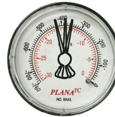
Caso o ponteiro se mova lentamente entre 14 e 15 pol Hg (380 a 420 mmHg) com o motor em marcha lenta, verifique as velas, os contatos do distribuidor e o sistema de ignição em geral.
