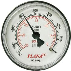
O manômetro indica uma leitura entre 17 e 21 pol Hg (450 a 550 mmHg) com o motor em marcha lenta (700 a 1000 rpm).
