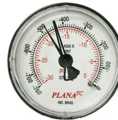
O ponteiro varia dois ou três pontos quando a válvula deveria fechar. Curtocircuitando as velas uma a uma, deverá indicar qual cilindro está com a válvula com defeito, com o motor em marcha lenta.
