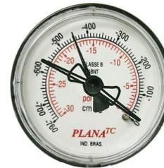
Quando o motor é acelerado e o manômetro vai à zero e volta para 23 pol Hg (580 mmHg) ou menos.
