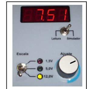
b) Antes de efetuar a simulação, é muito importante verificar a faixa de trabalho do sensor a ser analisado, pois alguns módulos de injeção podem sofrer avarias caso o aparelho seja mal utilizado. A maioria dos sensores trabalham na faixa de 5 Volts (Fig.II-Simulação e escala 5 Volts), mas alguns trabalham nas faixas 1.5 Volts como ex. Sonda Lambda (Fig.I – Simulação e escala 1,5 Volts) e outros trabalham na faixa de 12 Volts como ex. sensor de nível de
