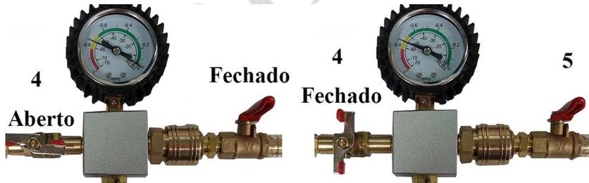
5 – Abra o registro localizado na mangueira engatada na entrada de liquido novo, e o liquido de arrefecimento será aspirado para o interior do sistema de arrefecimento. Quando o ponteiro do vacuômetro não baixar mais, o sistema estará OK. Caso necessário, complete o sistema com o liquido ou refaça o processo de vácuo.
