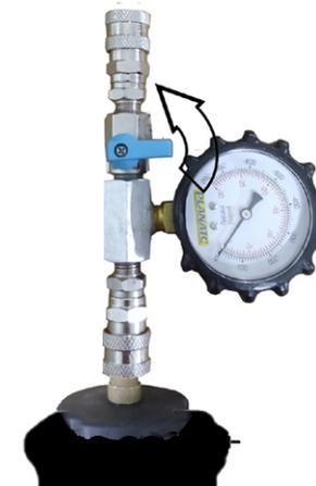
3 – Conecte o corpo gerador no corpo do manômetro com o registro fechado.
