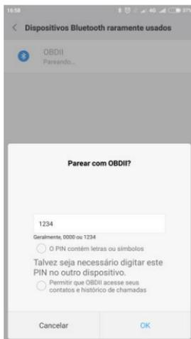
2º Após parear o Conector OBD2 Bluetooth, abra o APP TORQUE e pressione na engrenagem que fica na parte inferior esquerda da tela do APP.
