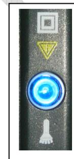
O Led acenderá quando a chave teste estiver na posição “I” ou “II”, após 20 s sem sinal o led apagará (nesta condição a caneta CTM continua consumindo, sempre que não for utilizar desligue a chave teste na posição “0”. Para acionar o led de iluminação pressione o Chave iluminação.
