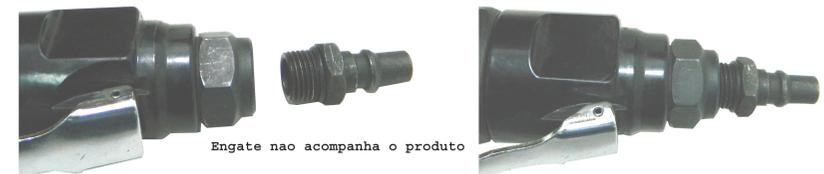
Observe sempre o tipo de engate rápido utilizado no seu sistema de ar comprimido.
