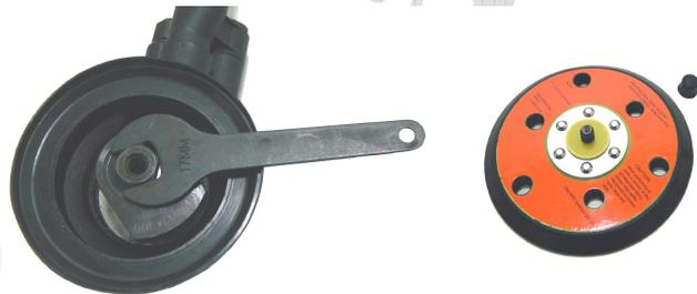
Rosqueie o disco no parafuso central e segure a chave, aperte manualmente o disco e remova a chave.
