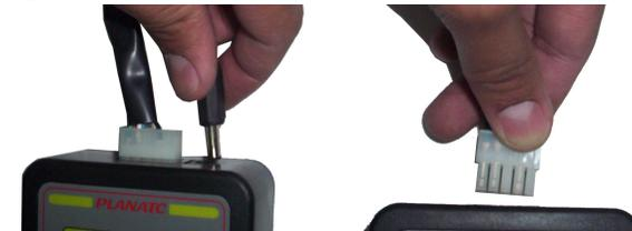
b) Conecte o outro cabo no equipamento e a outra extremidade na válvula solenóide a ser acionado.
