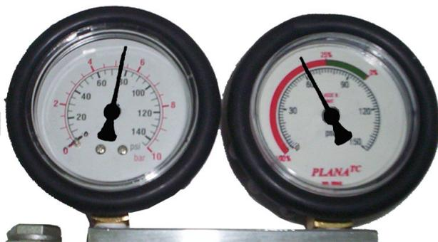
Manômetro 1º com 100psi e manômetro 2º com 65psi (aproximado), abaixo da escala verde é considerado ruim, neste exemplo, o cilindro testado está RUIM (com Vazamento).
