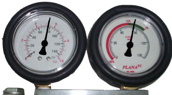
Manômetro 1º com 100psi e manômetro 2º com 95psi (aproximado), até 25% (escala verde) é considerado normal, neste exemplo, o cilindro testado está OK.
